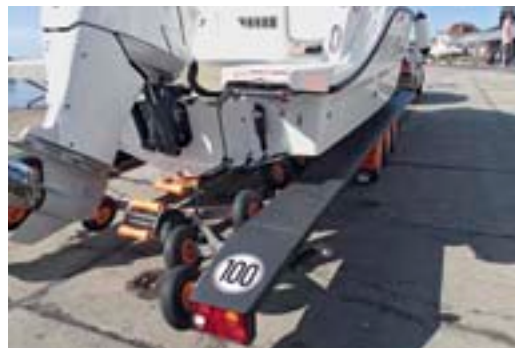
Der Testtrailer war ein Dreiaxser aus der niederländischen Hängerschmiede Vanclaes. Edelstahl, wasserdichte LED-Leuchten, Gangborde, wasserdichte Radlager: nur einige seiner Vorzüge.
