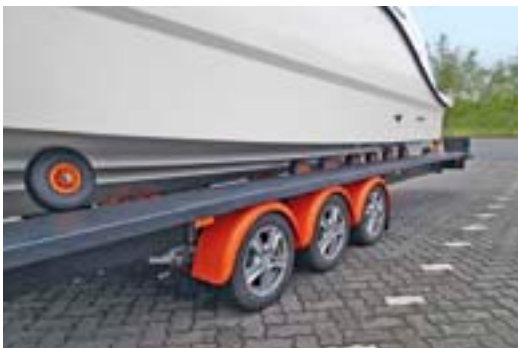
Der Testtrailer war ein Dreiaxser aus der niederländischen Hängerschmiede Vanclaes. Edelstahl, wasserdichte LED-Leuchten, Gangborde, wasserdichte Radlager: nur einige seiner Vorzüge.
