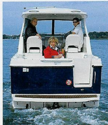
Kantiges Heck mit steuerbordseitigem Zugang zum 53 cm tiefen Steg
