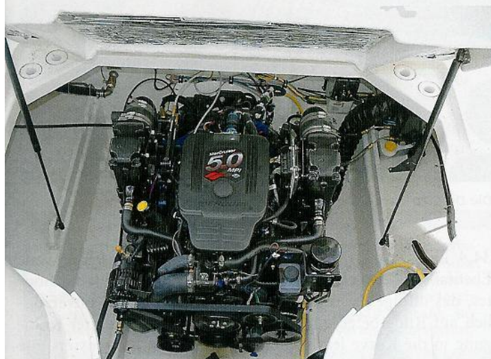
V8-Power unter der Plicht: MerCruisers 194 kW starker 5.0 MPI
