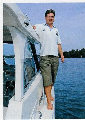
Die 11 cm breiten Gangborde sind strukturiert
