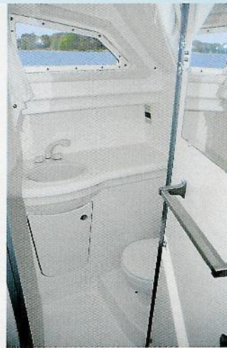
178 cm hohe Sanitärabteilung mit Pump-Toilette und Dusche
