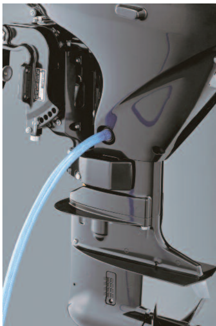
Leicht zugänglicher Spülanschluss für Frischwasser
