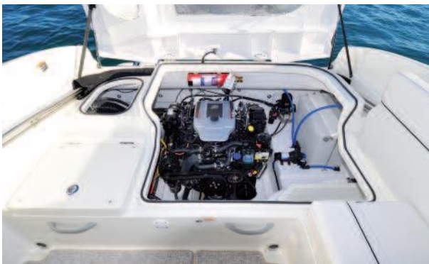
Augenweide für Technikfreaks, der sauber installierte MerCruiser 4.3 MPI, ECT/A1.
