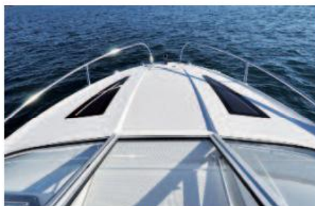
Vorschiff mit Antislipstruktur und Lichtschlitzen.
