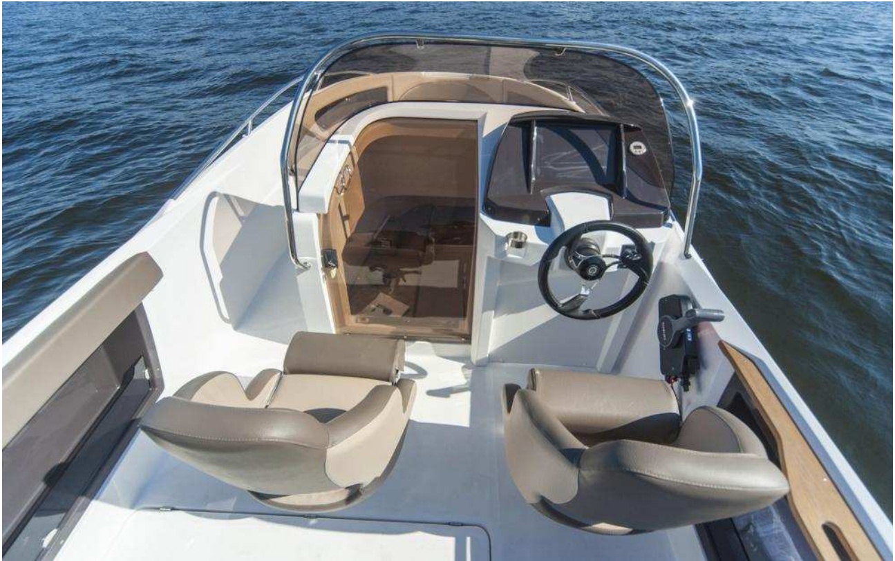
Übersichtlich: Steuerstand mit Handflauf und Niedergang in die Schlupfkajüte der Konsole. Foto: Dieter Wanke
