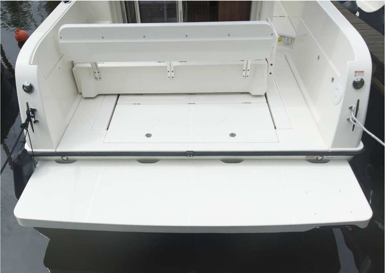
Verrückt: Die Rücksitzbank gleitet auf Schienen nach vorn und schafft so mehr Platz auf der Schwimmplattform. Foto: Dieter Wanke
