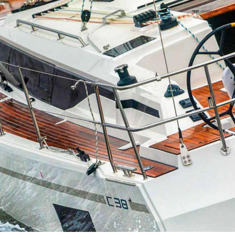
Minuten, wobei das komplette Reffmanöver vom Niedergang aus durchgeführt werden kann: Großfall und Reffleinen sind zu den Winschen und Fallstoppern beiderseits des Niedergangs geführt, eine saubere und vor allem sichere Sache. Nass werden muss man beim Reffen hier an Bord normalerweise nicht, ganz gleich, wie hoch der Seegang!
