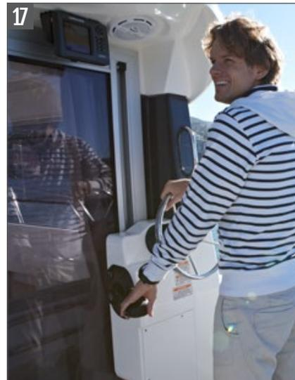
Cockpit-Steuerstand und 7'' Elektronik (GPS/Chartplotter vernetzt mit Haupt-System) für zweiten Steuerstand mit Wetterschutz
