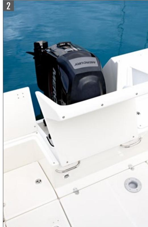
Klappbare Sitzbank ermöglicht vollständiges Auftrimmen des Motors
