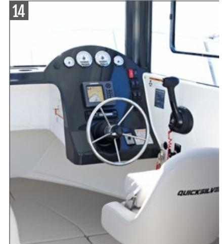
Integrierter Steuerstand mit Hydrauliklenkung, SmartCraft Instrumentierung, Platz für GPS/Chartplotter, Stereoanlage und 12V-Anschluss
