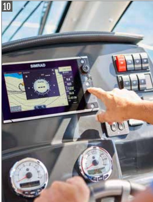
Integrierter Steuerstand mit SmartCraft Instrumentierung, Platz für GPS/Chartplotter
